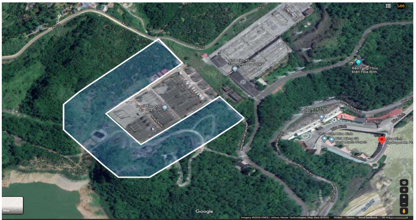
Рисунок 4.22 – Схема организации минерализованной полосы на действующей трансформаторной подстанции с масляными трансформаторами Хоа-Бинь района Хоа-Бинь
